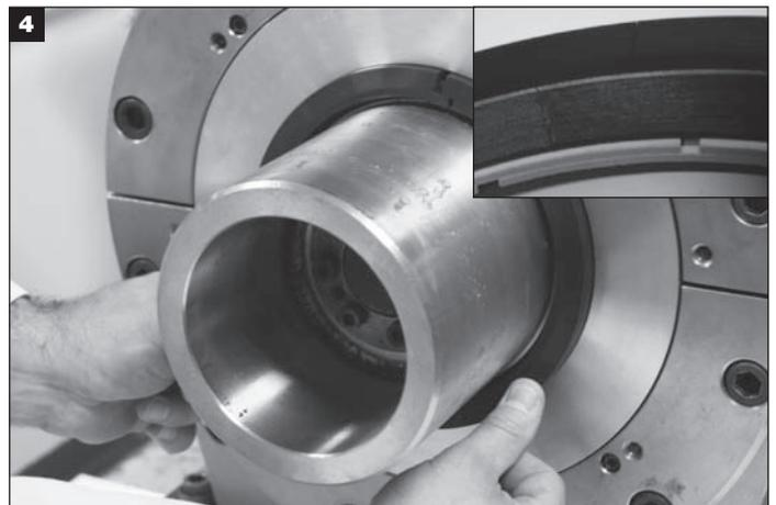
Aplique fuerza según resulte necesario para presionar el sello uniformemente dentro de la caja. Comience presionando las juntas primero hacia la posición de las 6 horas.
